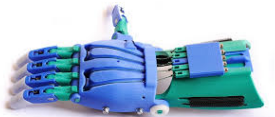
Prothèse imprimée et assemblée
